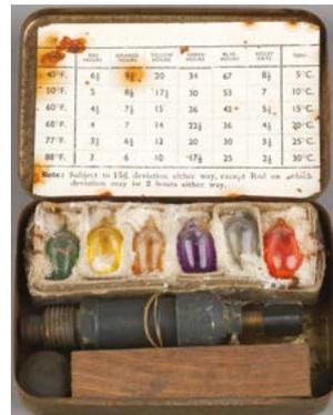
**23. AC Delay Mk 1 SOE livré dans sa boîte avec des ampoules d'acétone et son allumeur chimique à retard**
