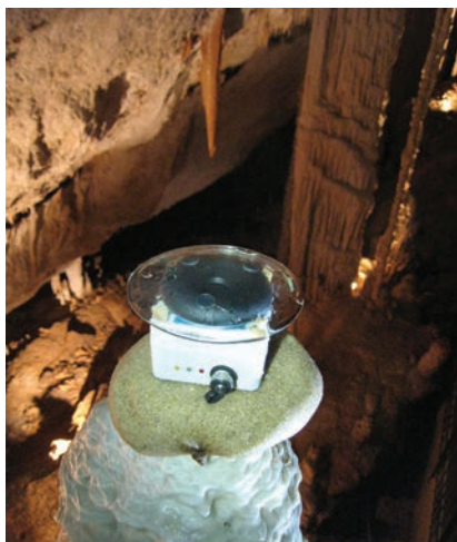
Compte-gouttes de type stalagmate installé dans la grotte de Villars (24). Il est surmonté d'un verre de montre destiné à récolter la calcite.
