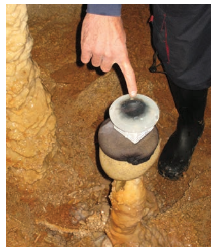
Compte-gouttes de type stalagmate installé dans la grotte de Villars (24). Il est surmonté d'un verre de montre destiné à récolter la calcite.
